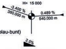
Neigungsbrechpunkt mit Angabe von Gefälle(-) und Steigung (+) in Prozent, Länge der Gefälle- (Steigungs-) Strecke und Halbmesser
